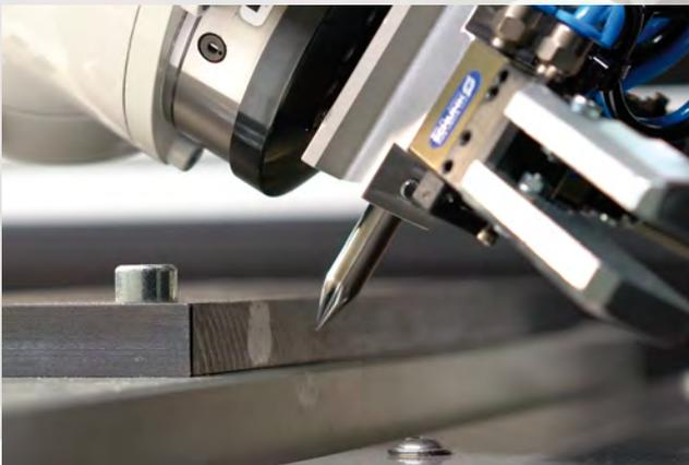
◀ Das selbstständige Vermessen des Roboters erlaubt sehr kurze Rüstzeiten ...
