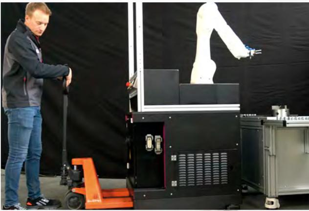
◀ Los geht es mit der groben Ausrichtung an der Maschine mittels einem Hubwagen oder Gabelstapler.
